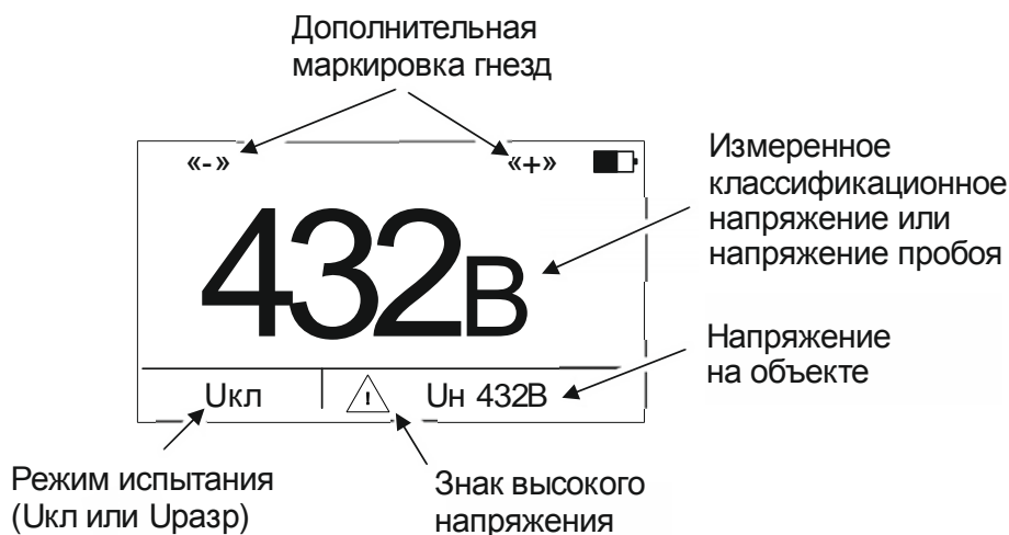
Рисунок 25 - Измерение квалификационного напряжения или напряжения пробоя разрядника
