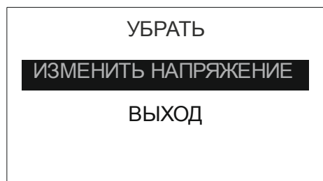
Рисунок 8 - Настройка пользовательского испытательного напряжения
