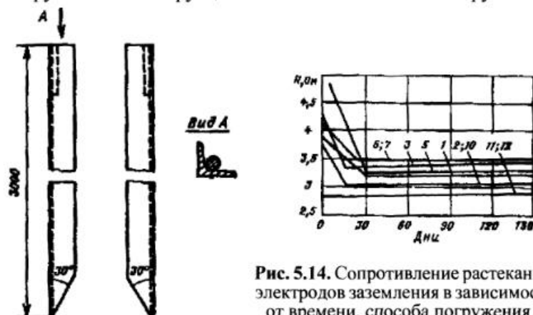
Рис. 5.13. Заземлитель из угловой стали
