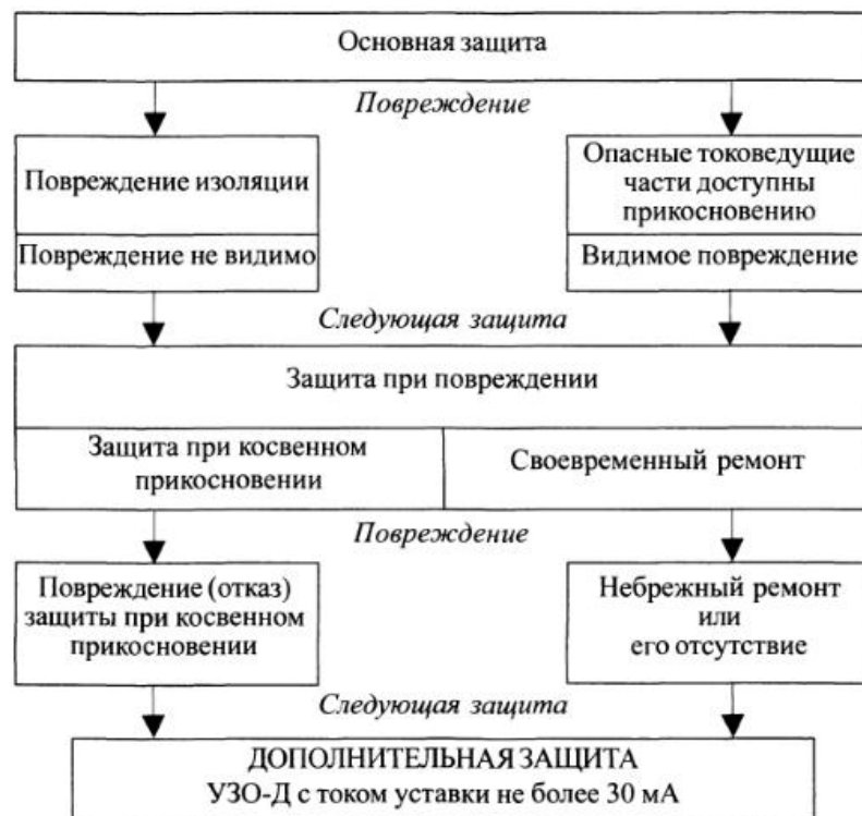
Рис. 4.2.1. Меры защиты от поражения электрическим током
